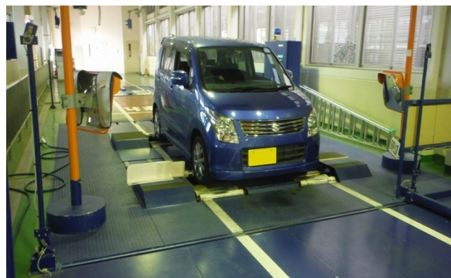
ブレーキテスト検査風景
